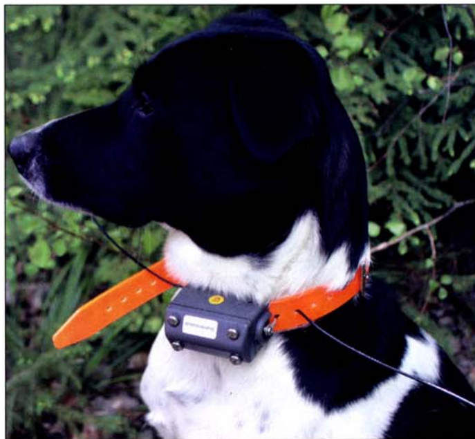
Den större Contact-sändaren med skallindikator ger bra koll på hundens position och hur den arbetar.
