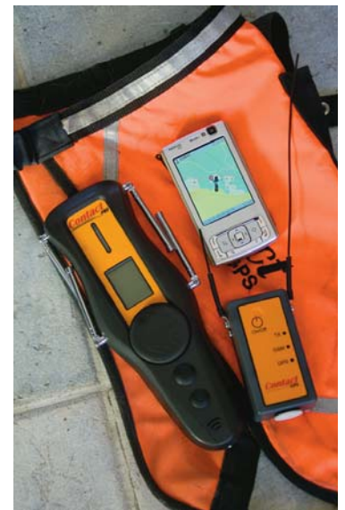
Hela Contacts utrustning med väst, handenhet och hundenheten med GSM-GPS och radiosändare. Mobiltelefonen på bilden är en Nokia N95 som visade sig fungera bra under jaktsäsongen. En stor färgskärm är en fördel när man ska titta på kartan.
